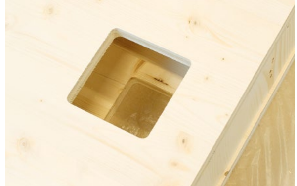
Fresatura di fori quadrati, lavorazione con raggio.
