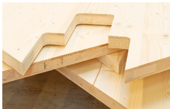
Rifinitura tramite la fresa a gambo (con raggio).
