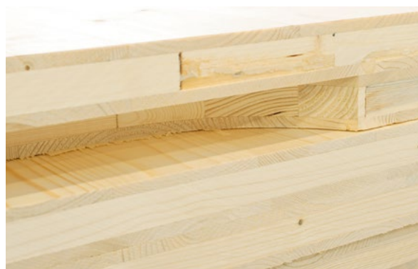
Fresa cilindrica – possibilità di fresatura dal lato sottostante (profondità max 100 mm dal lato).
