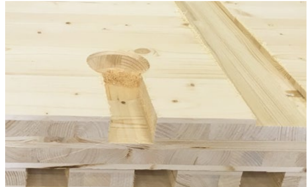
2. Fresa – fresatura di scanalature prima dell'incollaggio pannelli.
