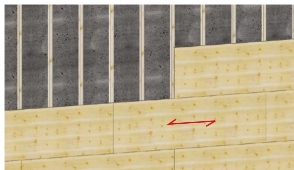
La costruzione verticale (parete) – messa in posa orizzontale
