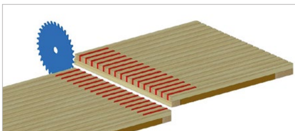
Taglio con lamelle protettive o disco da taglio più sottile
